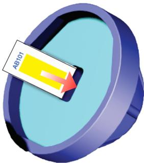
Wenn sich weder Luft noch andere nicht kondensierbare Gase in der Kammer befinden, durchdringt der Dampf das Testpaket schnell und gleichmäßig, und der Indikator zeigt eine gleichmäßige Farbänderung.
