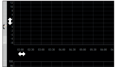
Abb. 13 Zeit- oder Werteachse durch Scrollen skalieren, sobald der Mauszeiger zum Doppelpfeil wird
