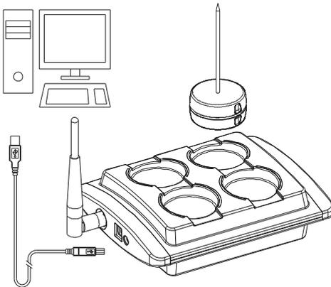
Zum Programmieren der Datenlogger wird ein passendes Interface (als Zubehör lieferbar) benötigt. Dieses Interface wird über den Universal Serial Bus (USB, als Zubehör lieferbar) mit dem PC verbunden und von dort oder von einem eigenen Netzteil (als Zubehör lieferbar) mit Strom versorgt.
