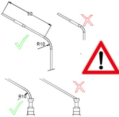
Biegen Sie den Fühler weder in den ersten 10 mm am Gehäuse noch in den 50 mm an der Fühlerspitze. Der Fühler könnte dadurch beschädigt werden.
