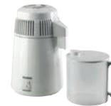
DIESES GERÄT ERZEUGT DURCH VERDAMPFEN VON LEITUNGSWASSER UND ANSCHLIESSENDE KONDENSATION DES DAMPFES DESTILLIERTES WASSER. DIE LEISTUNG LIEGT BEI CA. 0,7 L WASSER PRO STUNDE BEI EINEM TANKVOLUMEN VON 4 L. DER AQUADIST ERFÜLLT DIE ANFORDERUNGEN ZUR ELEKTROMAGNETISCHEN VERTRÄGLICHKEIT (2004/108/CE) UND NIEDERSPANNUNG (2006/95/CE).
