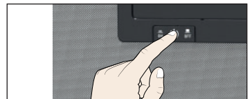
Abb. 1 Gerät ausschalten durch Drücken des Hauptschalters
