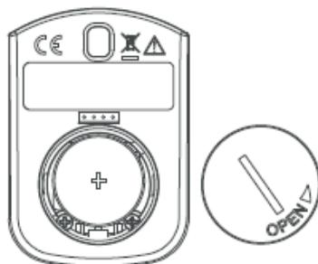
Direkt nach dem Einlegen der Batterie führt das Gerät einen Selbsttest durch. Dabei werden alle Segmente auf dem Anzeigefeld sichtbar und die LED blinkt zehn Mal.
