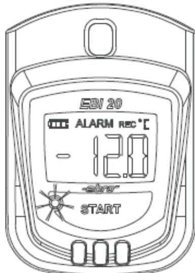
Das Gerät kann so programmiert werden, dass es optisch Alarm signalisiert, wenn der Messwert für die Temperatur bzw. die relative Feuchte den bei der Programmierung festgelegten Soll-Bereich (oberer und unterer Grenzwert) verlässt. In diesem Fall erscheint am oberen Rand des Anzeigefeldes die Zeichenfolge „Alarm“. Falls programmiert, blinkt außerdem die rote Leuchtdiode.
